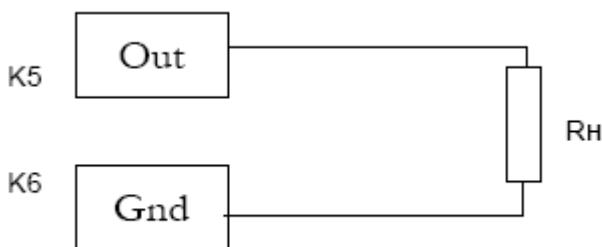
По исполнению выхода WAD-A(2A)-MAX может поставляться в двух вариантах: с выходом по напряжению и с выходом по току. В зависимости от этого, к нагрузке предъявляются противоположные требования. Для выхода по току (20mA) полное сопротивление нагрузки (с учётом сопротивления соединительных проводников) не должно превышать 500Ом (510Ом). Если выход у канала по напряжению, то 500Ом является, наоборот, минимальным значением.
