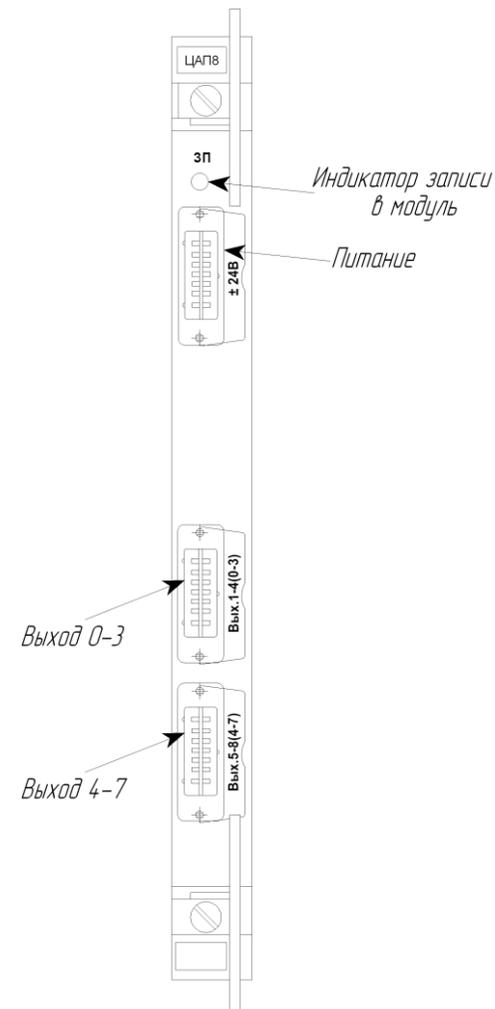
Рисунок 1 – Модуль цифро-аналогового преобразования ЦАП8.
