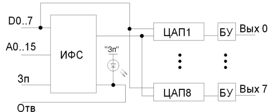
Рисунок 3 – Модуль цифро-аналогового преобразования ЦАП8.
