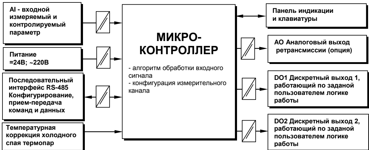
Рисунок 3.2 - Структурная схема индикаторов ИТМ-111, ИТМ-111В
