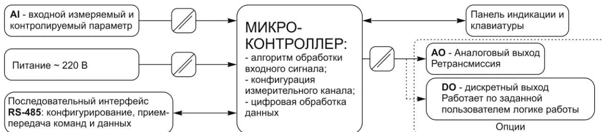
Рисунок 3.2 - Структурная схема амперметра ИПМ-3
