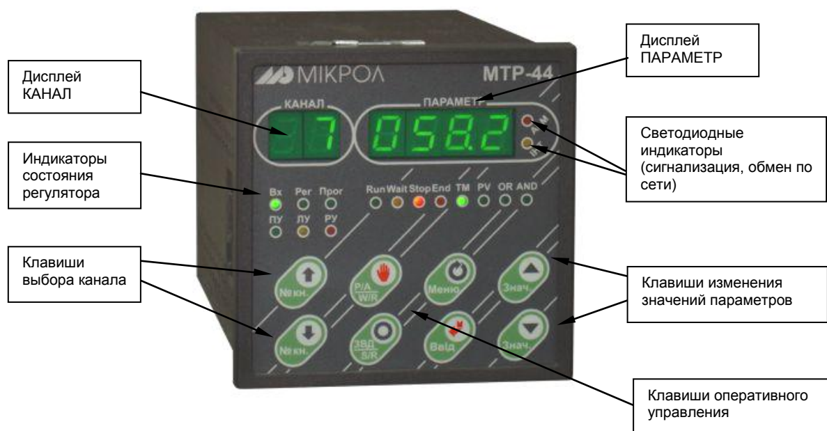
Рисунок 5.1 - Внешний вид передней панели регулятора МТР-44
