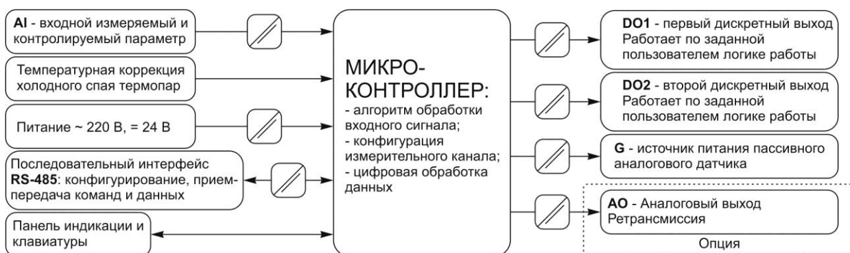
Рисунок 3.2 - Структурная схема индикатора ИТМ-110
