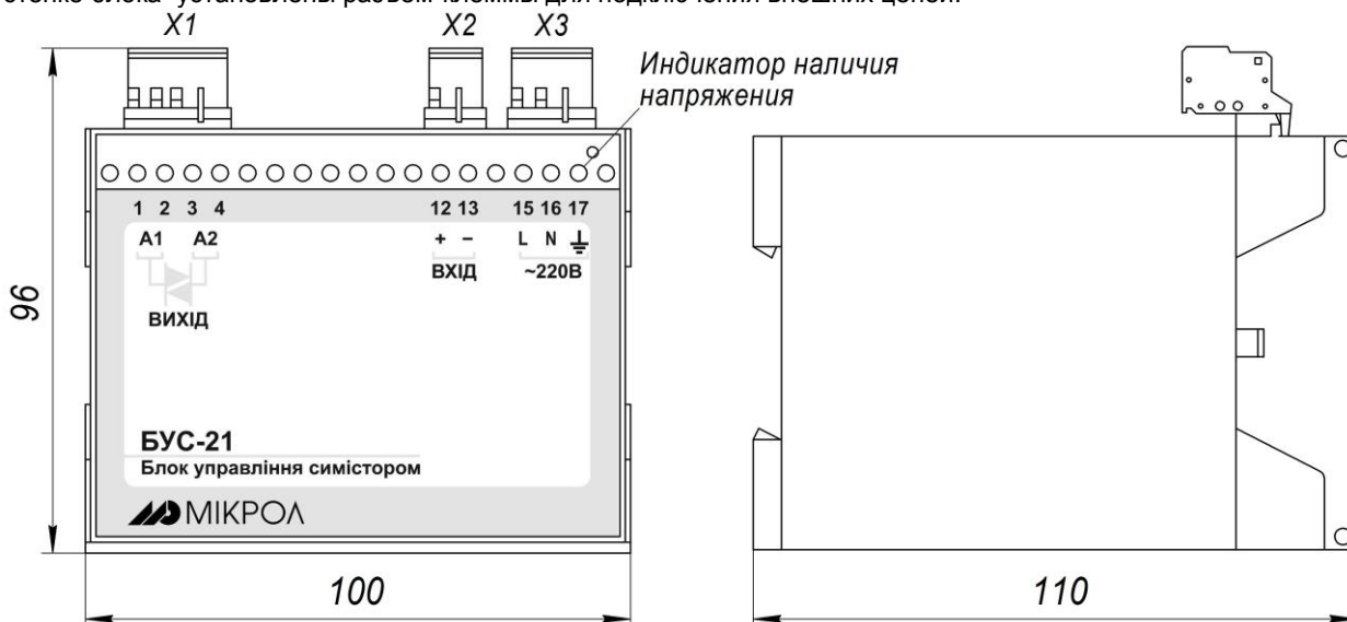
Рисунок 1.4 – Внешний вид и габаритные размеры блока БУС-21
