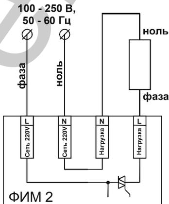
При подключении нагрузки следует учитывать, что клеммы «Сеть 220V – N» и «Нагрузка – N» соединены между собой внутри модулятора.
