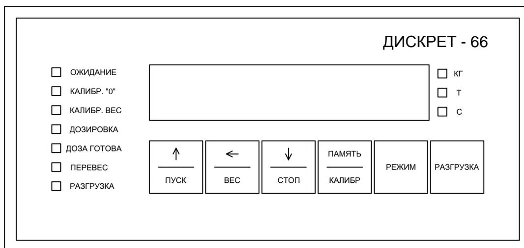
Элементы индикации включают шестизначный семисегментный светодиодный дисплей и 10 светодиодов.
