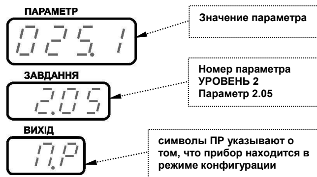
Рисунок 4.4 – Индикация значения параметров конфигурации и их номеров
