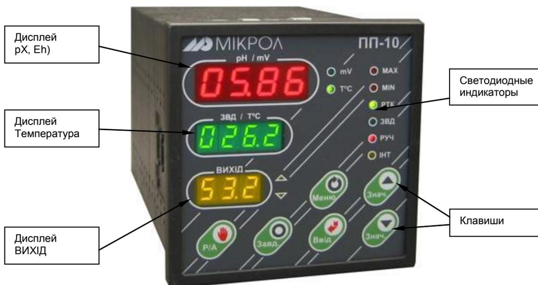
Рисунок 5.1. Внешний вид передней панели преобразователь-регулятора ПП-10
