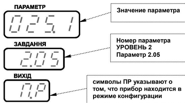
Рисунок 6.3. Индикация значения параметров конфигурации и их номеров.
