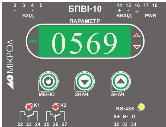
Рисунок А.1 – Внешний вид передней панели преобразователя БПВІ-10
